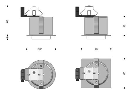
Material: Aluminium · erhältlich in zylindrischer bzw. quadratischer
