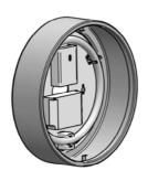
1. Leuchte and Wand oder Wanddose montieren. Die beiden Federn für Festhalten der Abschirmung senkrecht positionieren. Siehe Fig. 1.
